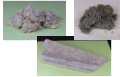
< 石綿を含有している可能性のある建築材 >
