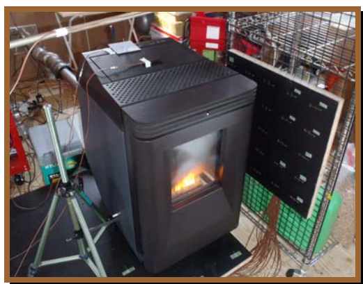
木壁表面温度（機器側面）
