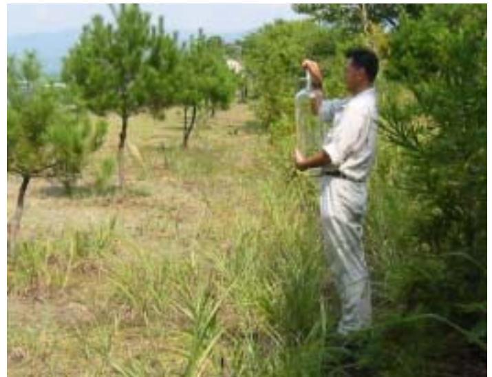
真空ピンによる臭気サンプリングの様子
