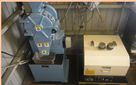
ウィレー粉砕機・振動ミル粉砕機 試料を細かく粉砕し、均一性の高い試料にして分析をします。
