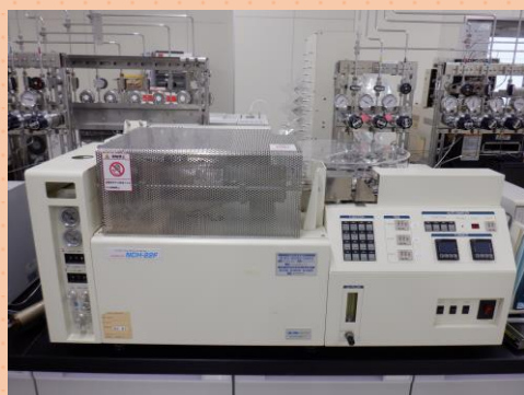
燃焼法元素分析装置 (株住化分析センター製 SUMIGAPH NCH-22F)
