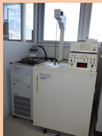
熱研式自動ポンベ熱量計 (株島津製作所製 CA-4AJ)
