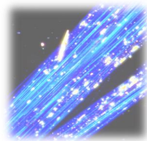
アスベスト繊維の例
