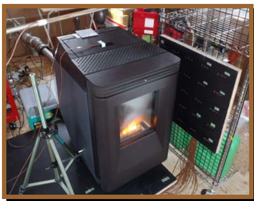
木壁表面温度（機器側面）
