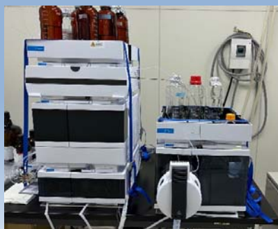
② 液体クロマトグラフィー・タンデム型質量分析計 (LC/MS/MS)
