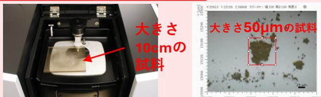
板状試料をそのまま測定 微小な試料は顕微システムで測定
